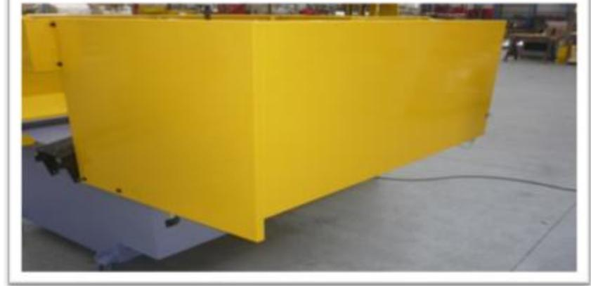
3/ Mettre en place le carter arrière, le fixer au bâti et sur le bras support
