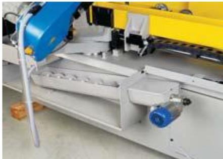
**Evacuateur à copeaux à vis sans fin motorisé**
