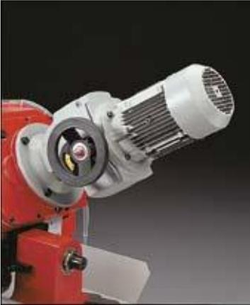
**Variateur mécanique de vitesses ( 20 à 100 m/mn )+ Moteur 1 vitesse en remplacement du moteur 2 vitesses**
