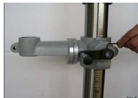
Befestigungsschraube zum Fixieren der Tischhalterung einsetzen.
