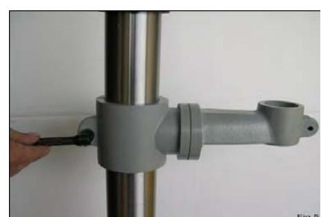
**4. Bohrtisch installieren und mit Schraube sichern (Abb. 6)**
