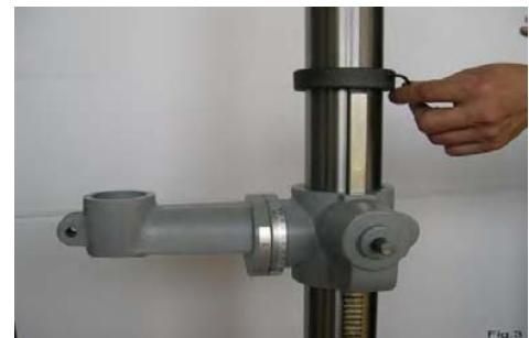
**3. Griff der Halterung und Befestigungsschraube installieren (Abb. 4, 5.)**
