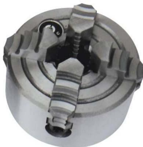
Figure 8-6 : Mandrin à quatre mors indépendants
