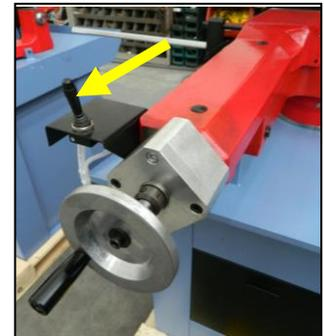
L'huile à utiliser pour ce dispositif est une huile pour circuit pneumatique de type **PNEUMOIL 01**.
