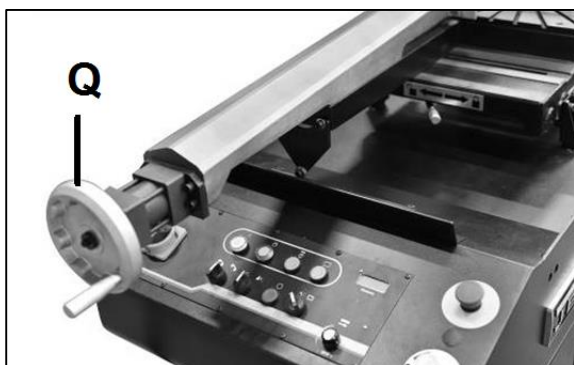
Figure 7-5 : Fonctionnement de l'étau
