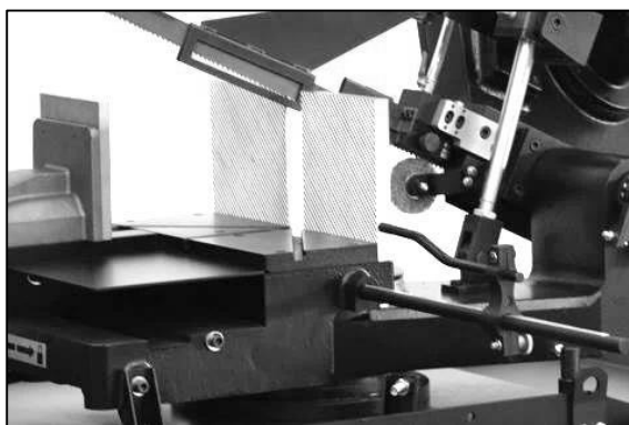
Figure 6-4 : Arrêt de matériau
