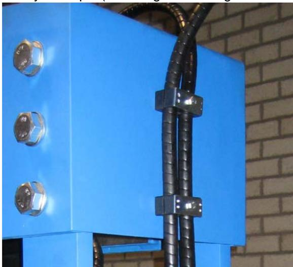
Image 10 Fixation avec des colliers de serrage
