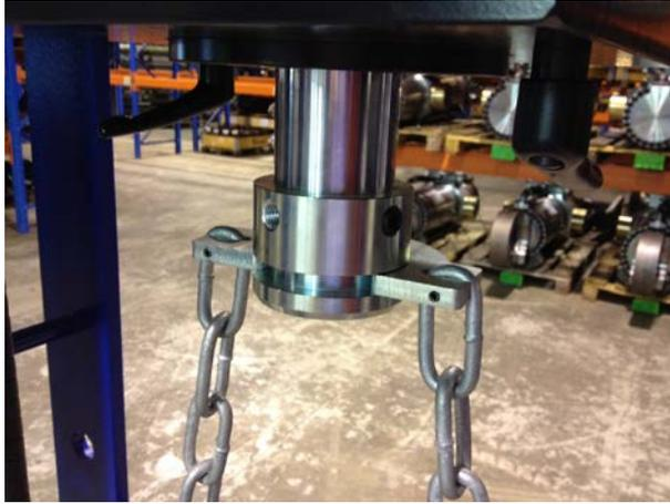
Image 18 Pont de chaîne de levage sur le haut du piston
