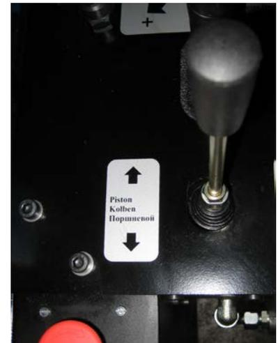
Image 13 Vanne de commande de direction
