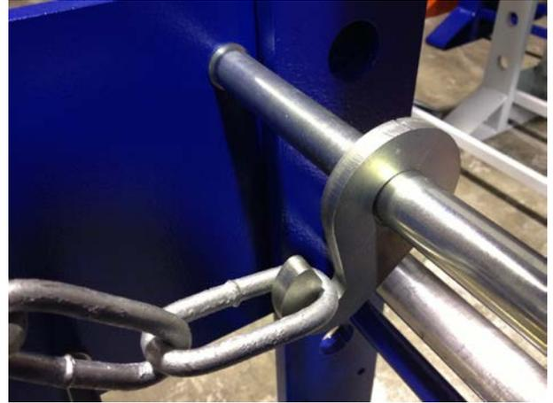
Image 19 chaîne de levage sur le crochet de la table
