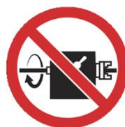
Toute pièce dépassant de l'extrémité arrière de la poupée fixe doit être recouverte sur toute sa longueur. Haut risque de blessure
