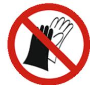
Beim Arbeiten mit dieser Maschine keine Handschuhe tragen.
