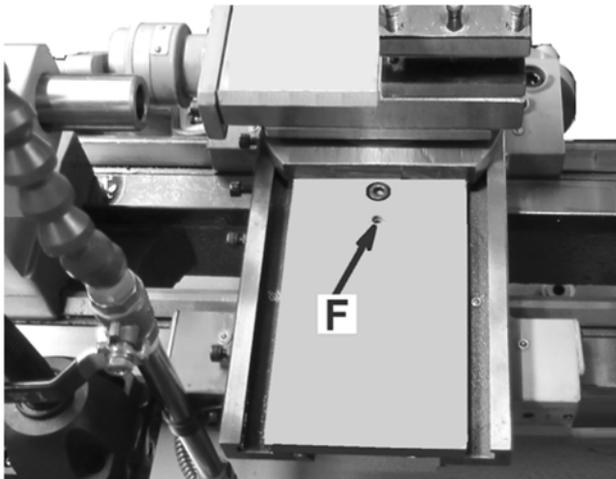
Abb. 11-4: Querschlitten-Spindel einstellen
