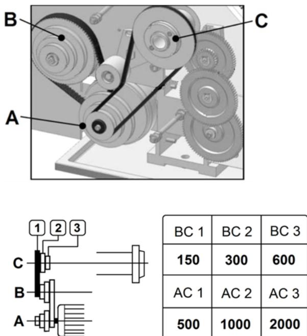
Abb. 8-1: Spindeldrehzahltable
