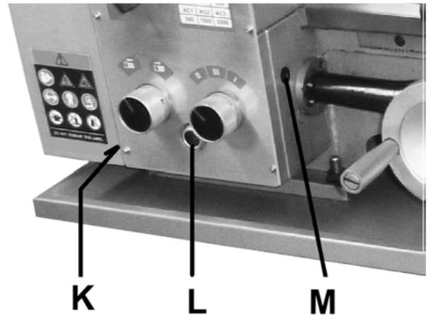
Abb. 11-1: Getriebeöl nachfüllen
