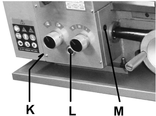
Figure 11-1 : Remplissage d'huile de la boîte de vitesses
