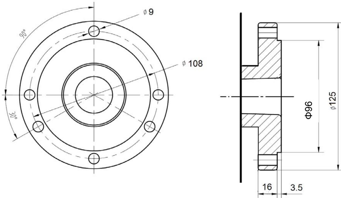
Abb. 4-1: Spindelkegelanbringung
