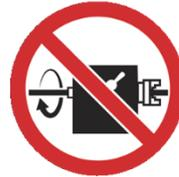
Werkstück-Stangenmaterial, das über das hintere Ende des Spindelstocks herausragt, muss über die gesamte Länge zum Schutz abgedeckt werden. Große Verletzungsgefahr
