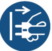
Die Maschine vor Ausführung aller erforderlichen Einstellungen oder Wartungsarbeiten vom Stromnetz trennen.
