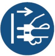
Réalisez tous les réglages de la machine ou la maintenance avec la machine débranchée de la source d'alimentation.
