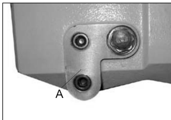
Das Getriebeöl muss periodisch ersetzt werden. Der erste Ölwechsel ist nach 6 Monaten nötig, darnach muss das Öl jährlich einmal gewechselt werden.
