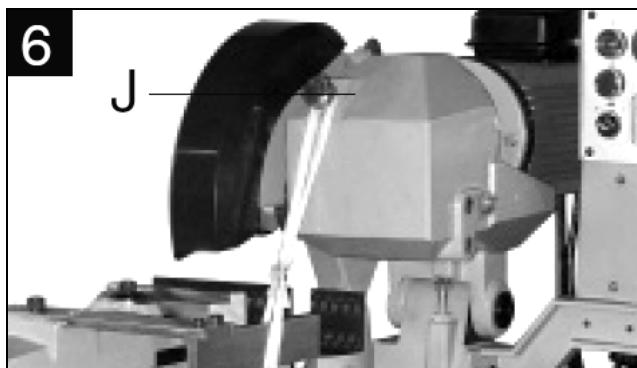
Visser le levier (L) avec la poignée inter (K) dans le perçage (J) puis le bloquer en position correcte à l'aide de l'écrou.
