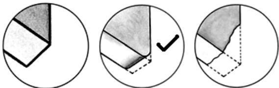
Führen Sie für 10 Minuten die Schnitte mit stark reduziertem Schnittdruck aus (Schneidkantenverrundung).
