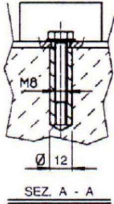
Stellen Sie die Maschine auf einem festen Zementboden so auf, dass ein Mindestabstand von 800mm zur Wand besteht. Verankern Sie die Maschine unter Verwendung von Schrauben und Spreizdübeln oder in den Zement eingelassenen Zugankern, sodass sie waagerecht steht (siehe Abbildung).
