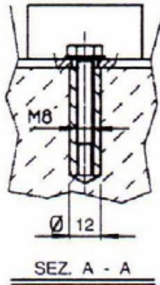
Placer la machine sur un sol en béton ferme, en respectant une distance de 800mm entre le dos de la machine et le mur. Le fixer au sol comme montré sur la Fig. en utilisant des vis et des éléments d'expansion ou des tirants enfouis dans le béton et veiller à ce qu'elle soit de niveau.
