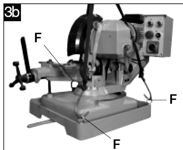
Die Maschine mittels eines Krans auf den Maschinenstand heben.
