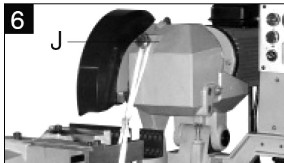
Den Zughebel (L) mit Startergriff (K) in das Gewindeloch (J) einschrauben und mit der Mutter in der korrekten Stellung festziehen.
