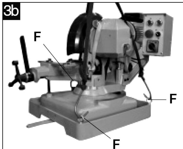
Soulever la machine à l'aide d'une grue pour la poser sur le socle.
