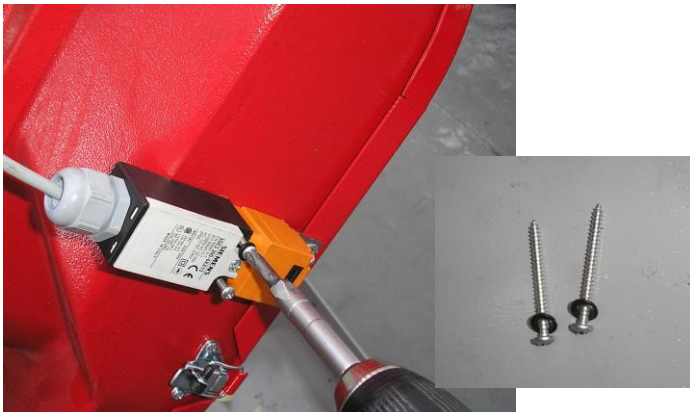
3/ Fixer le fin de course avec les 2 vis 3,9x32
