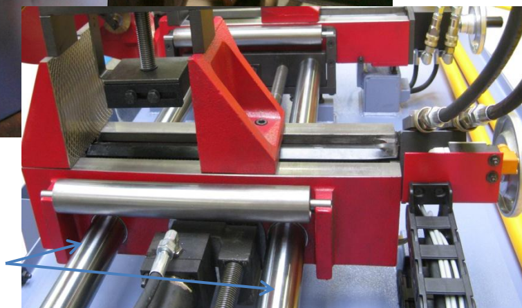
Colonnes de guidage du bloc avance-barre
