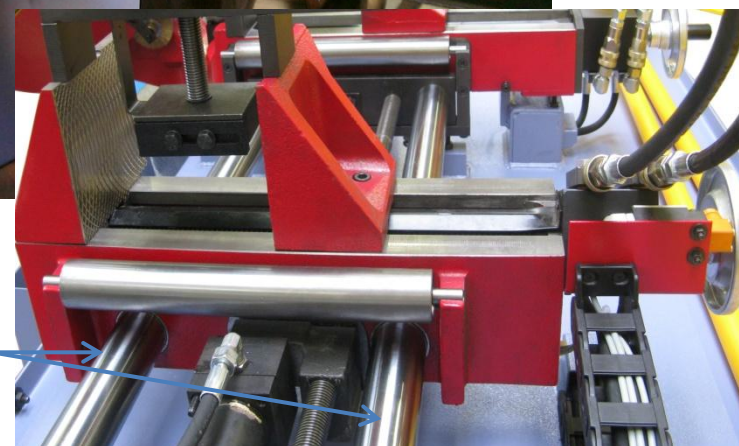
Colonne guidage bloc avance-barre
