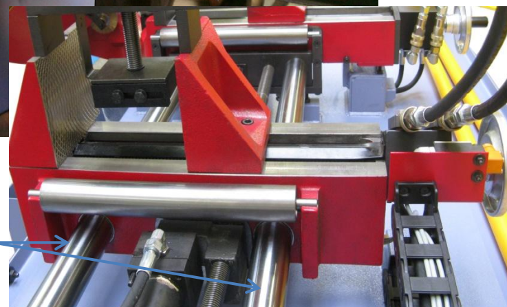
Colonne guidage bloc avance-barre
