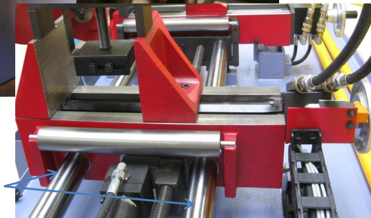
Colonnes de guidage du bloc avance-barre
