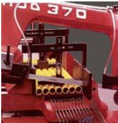
Dispositif de maintien pour coupes en nappes
