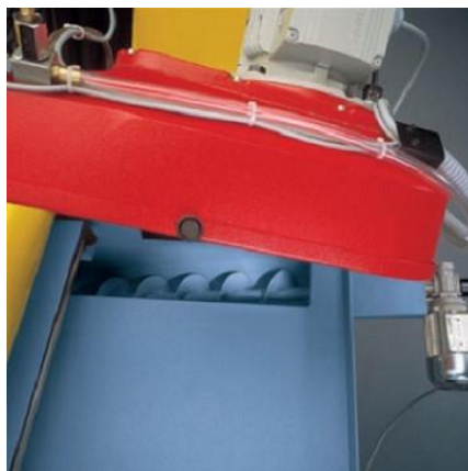
Evacuateur à copeaux à vis sans fin motorisé
