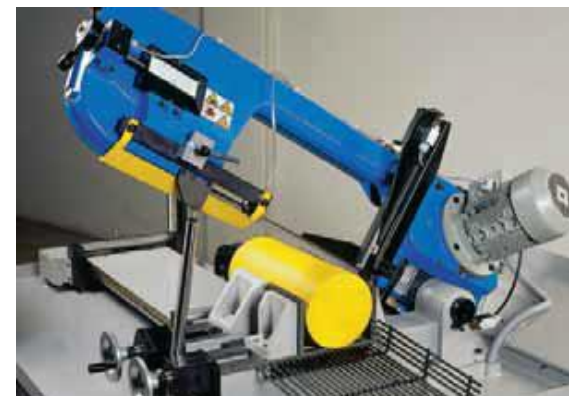
Vérin de serrage et d'avance- barre positionnés de part et d'autre du ruban
