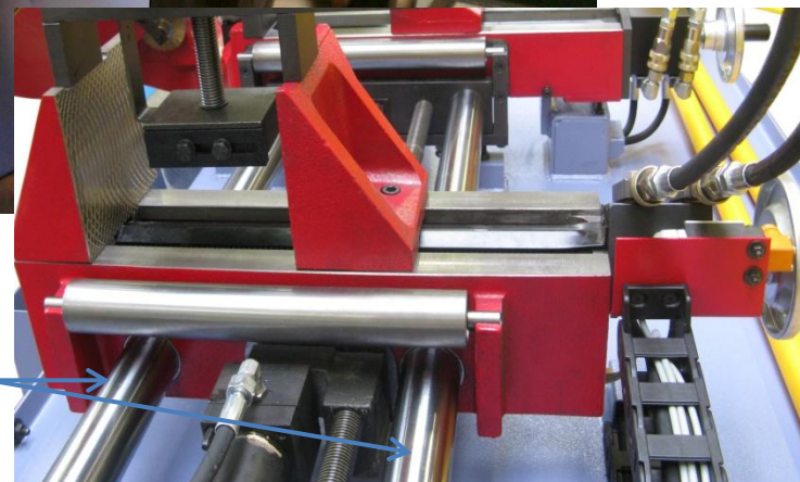
Colonne guidage bloc avance-barre
