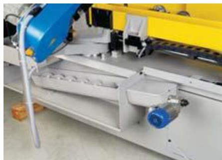
Evacuateur à copeaux à vis sans fin motorisé
