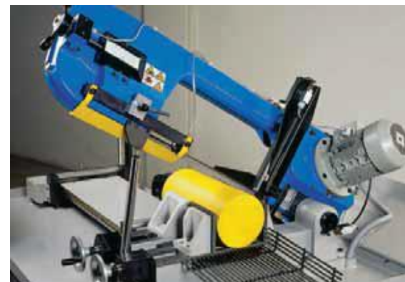
Etaux de serrage et d'avance-barre positionnés de part et d'autre du ruban
