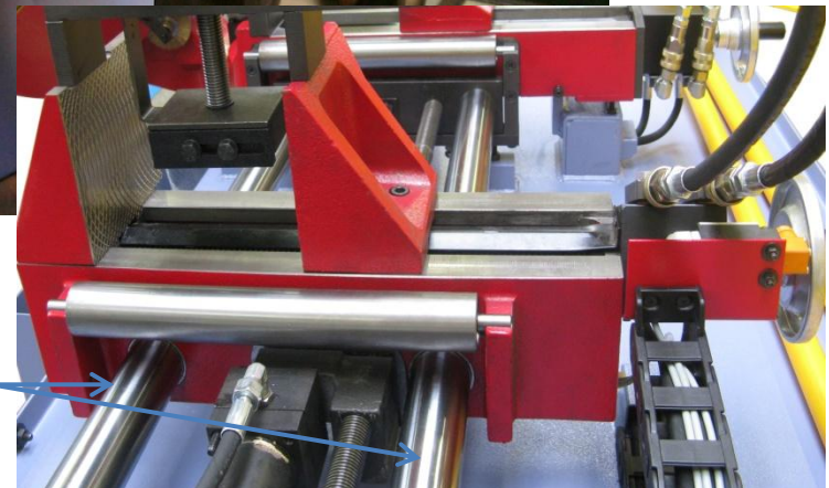
Colonne guidage bloc avance-barre
