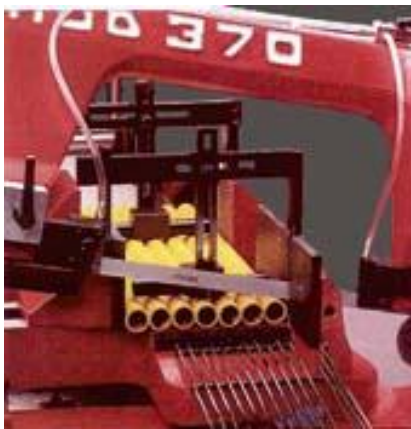
Dispositif de maintien pour coupes en nappes
