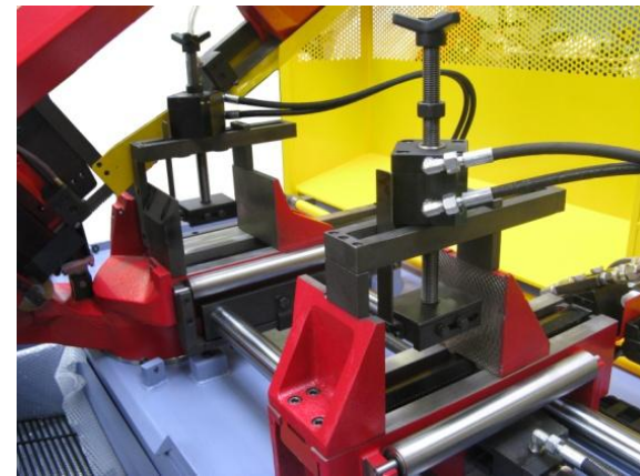
Dispositif de serrage vertical hydraulique pour coupes en paquets Capacités maxi : 200x130 mm
