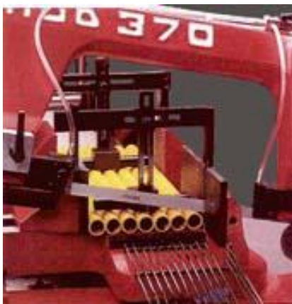
Dispositif de maintien pour coupes en nappes
