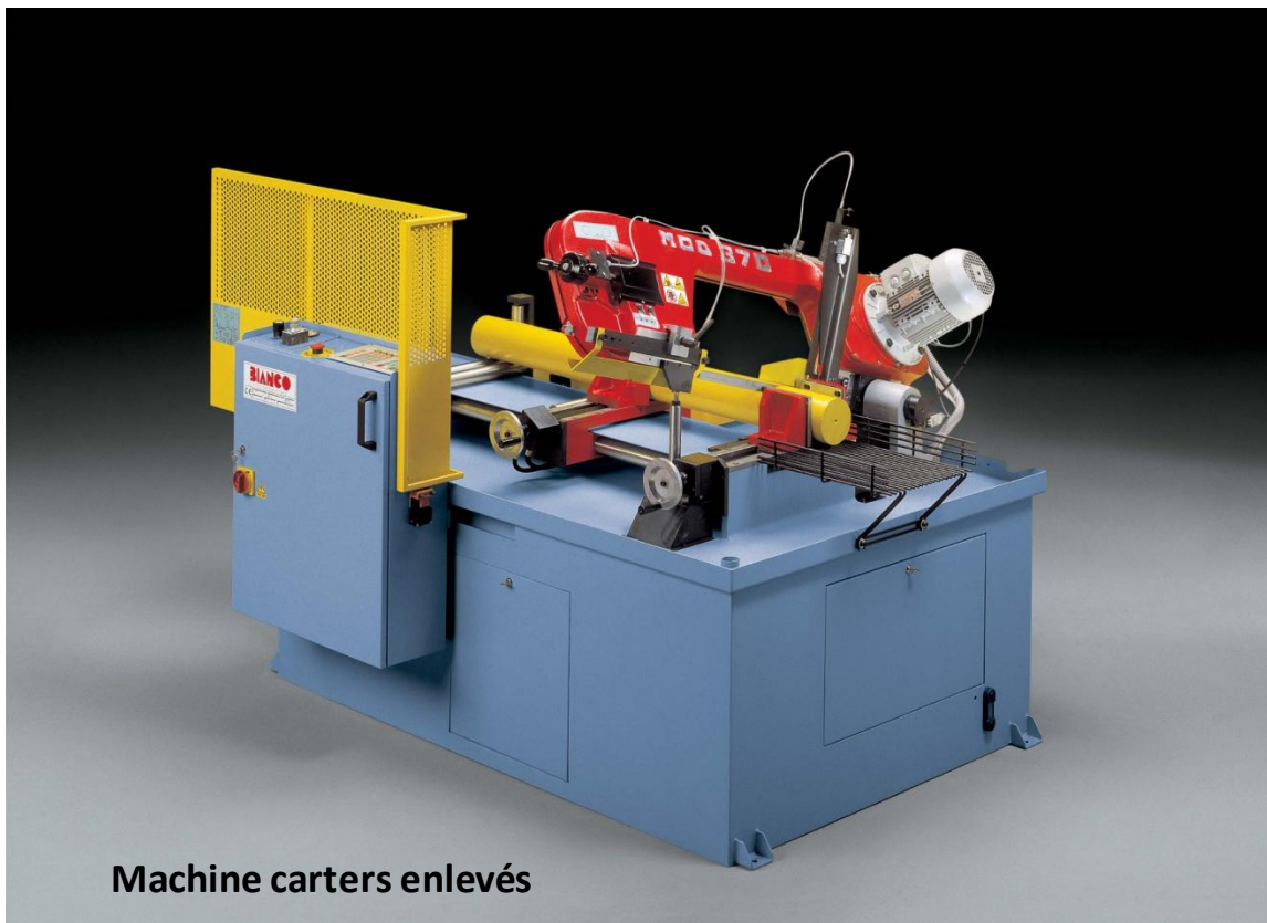
Etaux de serrage et d'avance-barre positionnés de part et d'autre du ruban
