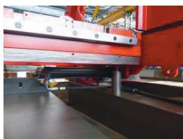
Déplacement latéral du bloc étau par vérin hydraulique
