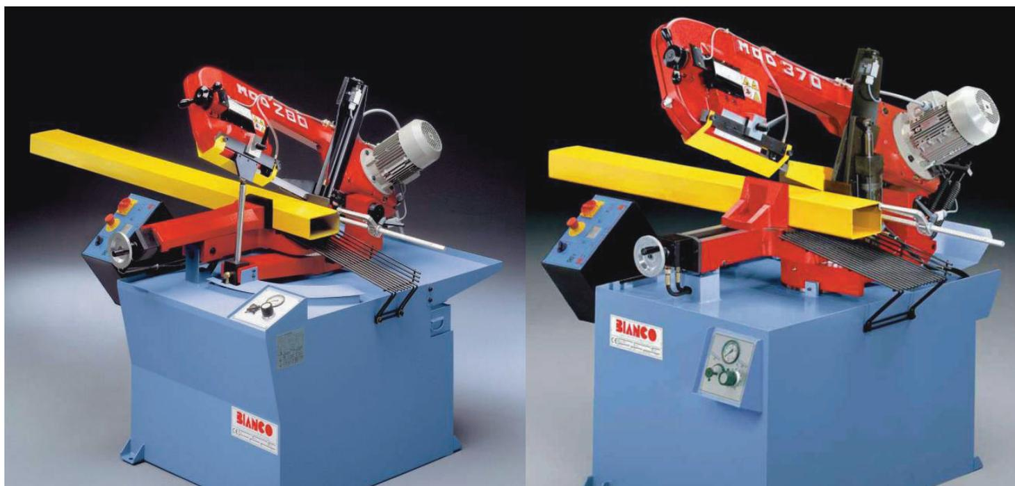
**Machines semi-automatiques, équipées d'un groupe hydraulique, pour la coupe de matériaux pleins et profilés en coupes droites et d'onglets jusqu'à 30° à droite.**
