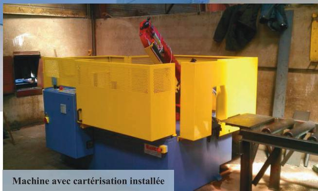
Machine avec cartérisation installée
