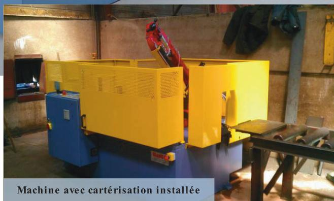
Machine avec cartérisation installée
