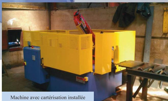
Machine avec cartérisation installée
