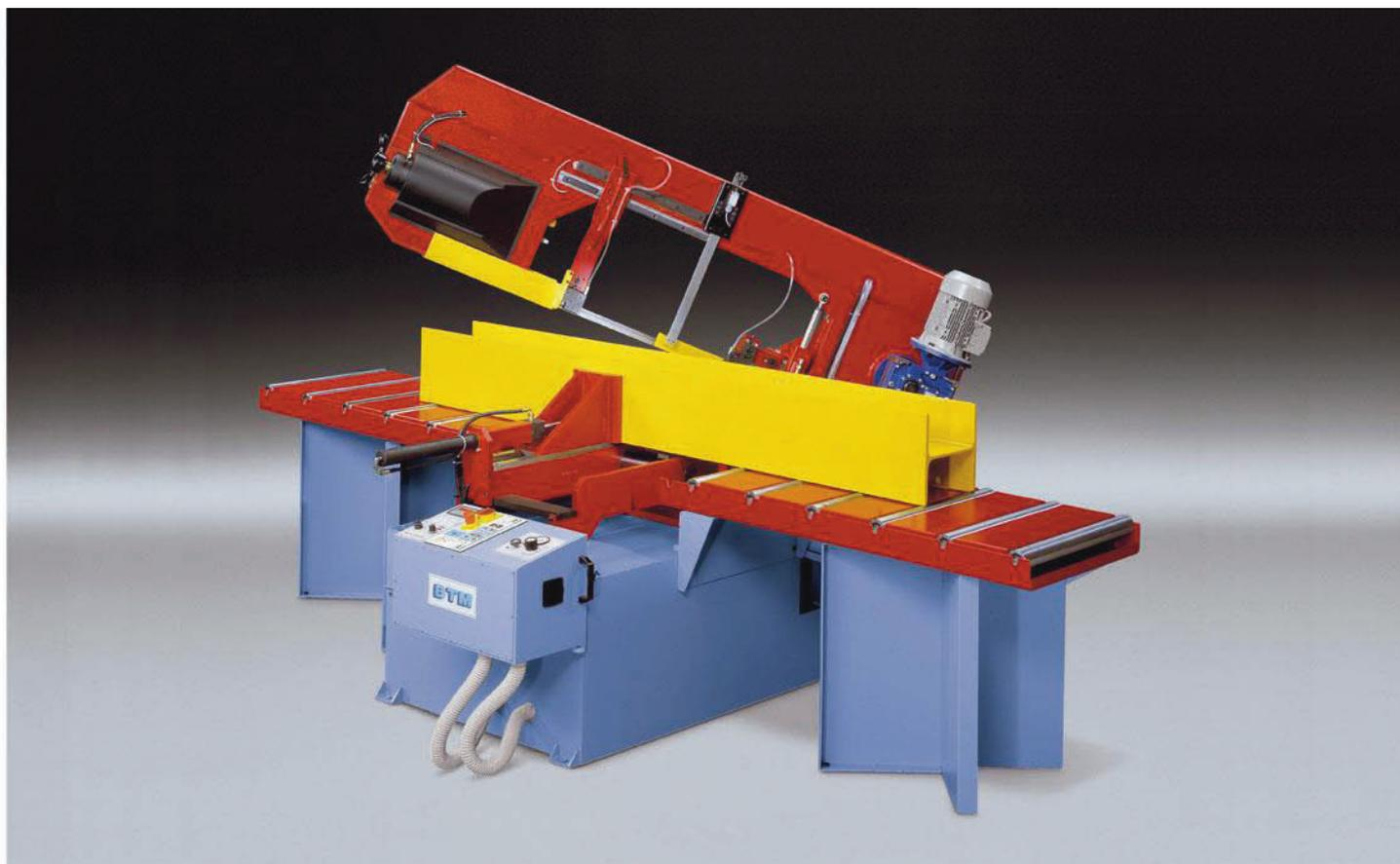
Machine Mod61.41SADS avec tables d'entrée et sortie (en option)
