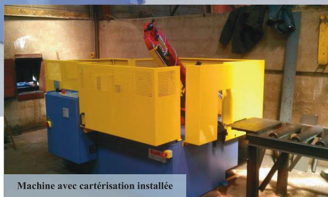
Machine avec cartérisation installée
