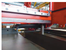
Déplacement latéral du bloc étau par vérin hydraulique
