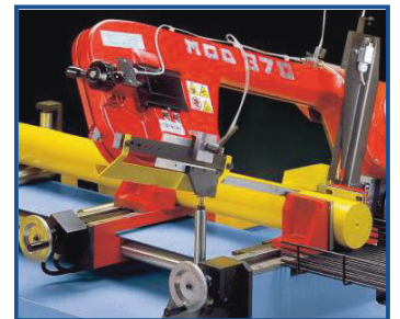
Étaux situés de part et d'autre du ruban sur Mod.370AF90°CNC (Chute de fin de barre réduite)
