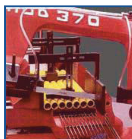
Maintien mécanique pour coupes en nappe
