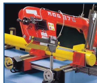
Etaux situés de part et d'autre du ruban sur Mod370AF90° (Chute de fin de barre réduite)
