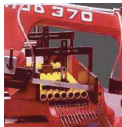
Maintien mécanique pour coupes en nappe
