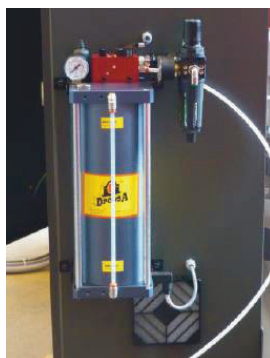
Dispositif de Micro- pulvérisation ( Nécessite une alimentation en air comprimé )
