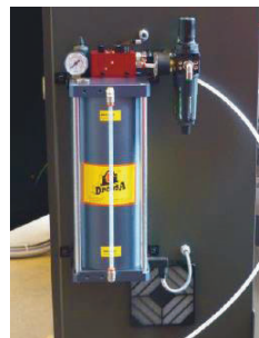
Dispositif de Micro- pulvérisation (Nécessite une alimentation en air comprimé)
