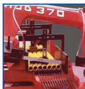
Maintien mécanique pour coupes en nappe
