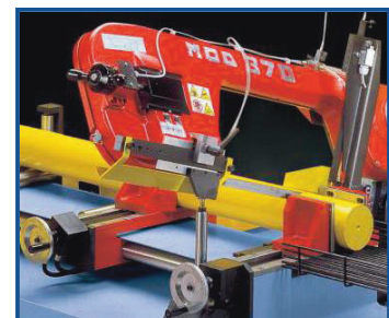
Etaux situés de part et d'autre du ruban sur Mod370AF90° (Chute de fin de barre réduite)
