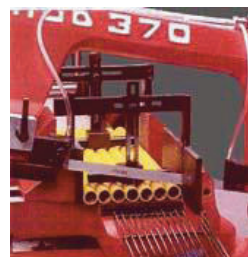
Maintien mécanique pour coupes en nappe
