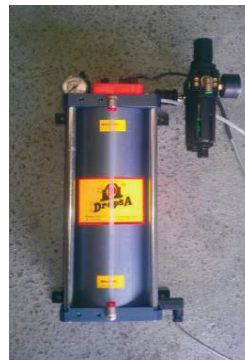
Dispositif de Micro- pulvérisation (Nécessite une alimentation en air comprimé)
