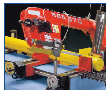
Étaux situés de part et d'autre du ruban sur Mod.370AF90°CNC (Chute de fin de barre réduite)
