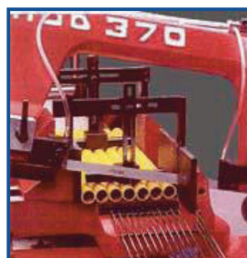
Maintien mécanique pour coupes en nappe
