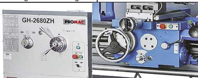
Schallemission: Schalldruckpegel( nach EN ISO 11202): Leerlauf Maximaldrehzahl LpA 82,4 dB (A)
