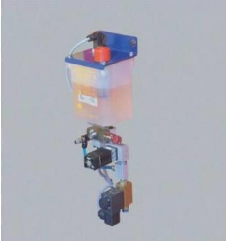
**DISPOSITIF DE MICRO-PULVERISATION
