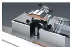
L'arbre de toupie a un diamètre de 30 mm et une hauteur utile de 120mm. Le réglage de la hauteur est de 140mm.
