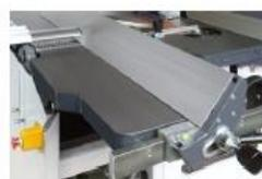
Le guide dégau de bonnes dimensions, grâce au support spécial, peut s'incliner de 90° à 45°. Les butées sont ajustables. A la position de 45°, le guide repose sur la table sans espace entre la table et le guide.
