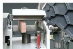
Le positionnement de la table de rabotage est simple et facile. Le passage en rabotage est 230mm.
