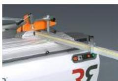
Le Guide butée de tronçonnage est inclinable de 2 x 45° ( en standard sur la machine).
