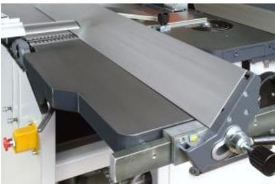
Le guide dégaude de bonnes dimensions, grâce au support spécial, peut s'incliner de 90° à 45°. Les butées sont ajustables. A la position de 45°, le guide repose sur la table sans espace entre la table et le guide.
