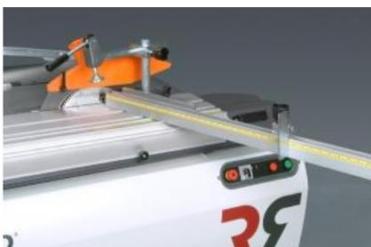
Le Guide butée de tronçonnage est inclinable de 2 x 45° ( en standard sur la machine).
