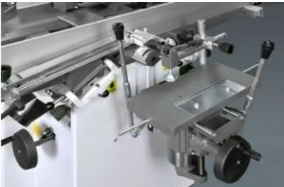
La mortaiseuse, facile à enlever, est pourvue de deux leviers escamotables et d'un mandrin de 0 à 16mm.
