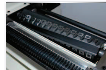
Avec arbre à lames en spirale et plaquettes quadruples réversibles
