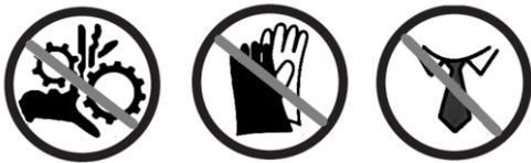
Bevor mit dieser Maschine gearbeitet wird, Krawatten, Ringe, Armbanduhr und anderen Schmuck ablegen und die Ärmel bis über die Ellbogen aufrollen.
