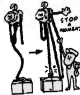
Die Last nicht in einem Stück anheben. Nach Anhebung der Last (die Kette ist gespannt) ca. 10cm über dem Boden, testen der Bremswirkung durch Anheben und Senken der Last.
