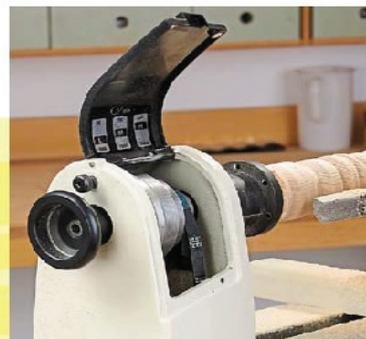
Zusätzlich kann die Rippenriemen-Übersetzung leicht dreifach verstellt werden – werkzeuglos!
