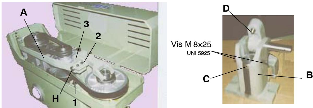
B – Introduire, comme indiqué dans la Figure 35 n° 2, les vis M8 x25 Extr. Cylindrique – 12.9 (UNI 5925 – DIN 915) dans les trous correspondants du logement du ressort B, pour maintenir ainsi le couvercle C.
