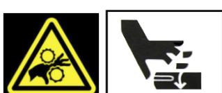
Um eine Berührung mit dem rotierenden Lüfterrad zu vermeiden sind nicht verwendete Absauganschlüsse immer abzudecken.
