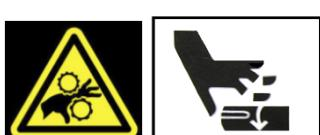
Afin d'éviter tout contact avec la roue de ventilateur en rotation, il faut toujours boucher les buses d'aspiration non utilisées.
