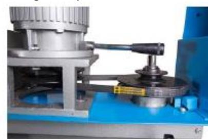
7. La tension doit être suffisamment lâche pour permettre un déplacement de 5 - 10 mm lorsque vous poussez la courroie par le côté.
