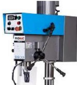
La tête de la machine est fixée à la colonne. Cela permet une plus grande intensité d'usinage des pièces.
