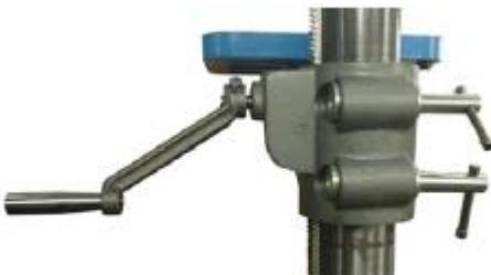
Zum Neigen des Tischs zunächst die Hebelverriegelung lösen, um den Tisch in die gewünschten Winkel zu neigen. Danach den Tisch arretieren.
