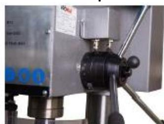
Un indicateur de la profondeur de perçage est fourni sur le côté de la tête de perçage. L'indicateur peut être réglé au niveau de la profondeur jusqu'à 12,5 cm. Le bouton de verrouillage se situe sur le côté, en haut du levier de fourreau.
