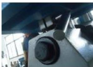
5. Durch Drehen des Spindel-/Pinolenvorschubhebels die Spitze des Bohrer- oder Gewindebohrereinsatzes in Kontakt mit der Werkstückoberfläche bringen und in dieser Position halten.
