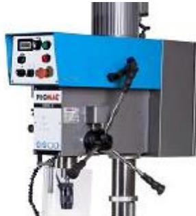
Der Maschinenkopf ist an der Säule fixiert. Dadurch ist größere Stabilität bei höheren Bearbeitungskräften gewährleistet.
