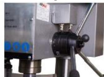
An der Seitenfläche des Bohrkopfs befindet sich eine Bohrtiefenanzeige. Die Anzeige kann auf Tiefen bis 12,5 cm eingestellt werden. Der Verriegelungsknopf befindet sich an der Seitenfläche oben am Pinolenhebel.
