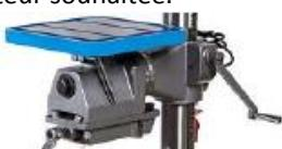
4. Utilisez un levier de verrouillage pour sécuriser la table.
