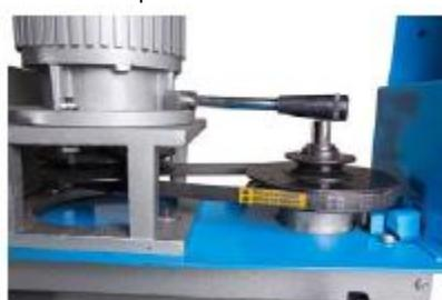
7. Die Spannung muss so eingestellt sein, dass eine Bewegung von 5 - 10 mm möglich ist, wenn von der Seite gegen den Riemen gedrückt wird.
