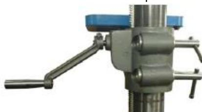
Pour incliner la table, desserrez le levier de verrouillage pour régler la table à l'angle souhaité, puis verrouillez la table à la bonne position.
