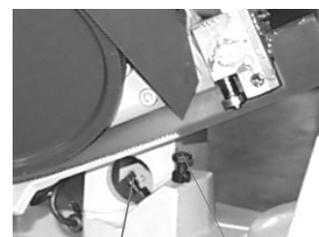
lorsque le bras de la scie soit dans la position extrême inférieure, les dents de la lame ne touchent pas la surface de la table. La vis de butée (G) est utilisée pour régler la distance entre la lame et la surface de la table. Une fois la distance ajustée, serrez le contre-écrou. La vis (F) est utilisée pour régler l'angle vers le haut du bras de la scie. Serrez le contre-écrou.
