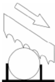
Sens de coupe de la lame de scie
